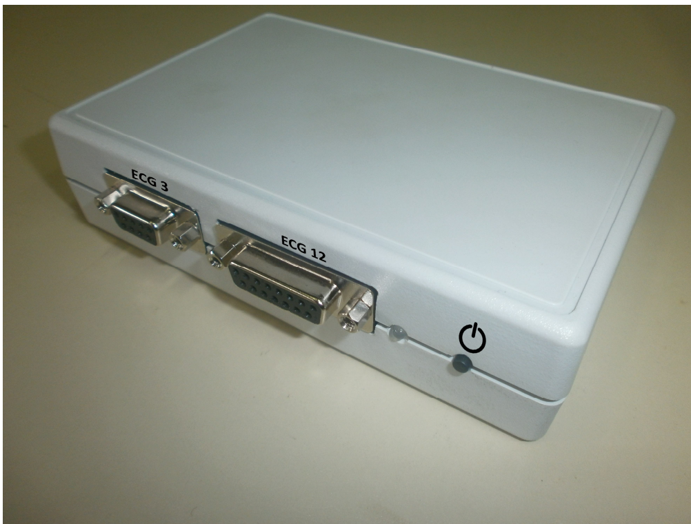
Sl. 1. Izgled prednje ploče ECG 1401 kalibracionog uređaja
