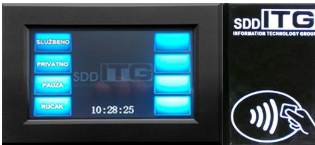
Sl.6 Eksterna antena ITGant-91 (ekran osetljiv na dodir: unos PIN koda ili funkcionalna tastatura, definisati prilikom poručivanja)
