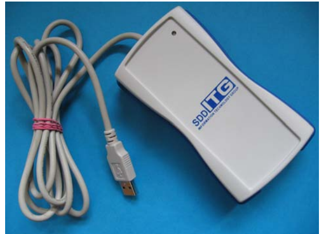
Сл.2 Ручни (лево) и стони RFID читач са USB интерфејсом
